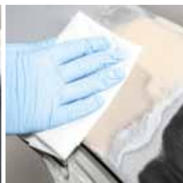
Fordampning i 5 min. før lakkering
