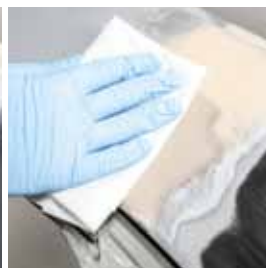
Fordampning i 5 min. før lakkering
