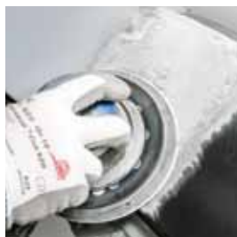
Sliping til jevn overflate
