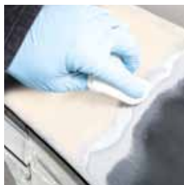
Påføring av BONDERITE M-NT 1455 W kun på metall. Skal være vått i 2 min.
